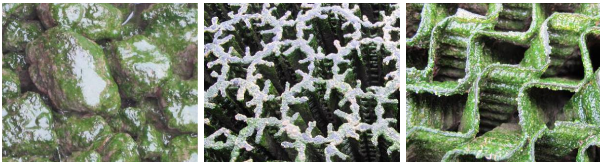
Figura 5: Biofilme aderido a diferentes meios suportes: pedra lava, plástico tubo colmeia e plástico estruturado de fluxo cruzado 60°.
